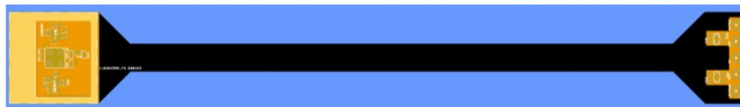
包含温度补偿的SiPM读出板 FPC 读出板
