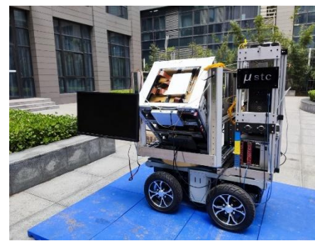
\mu STC宇宙线缪子成像系统（中科大）
