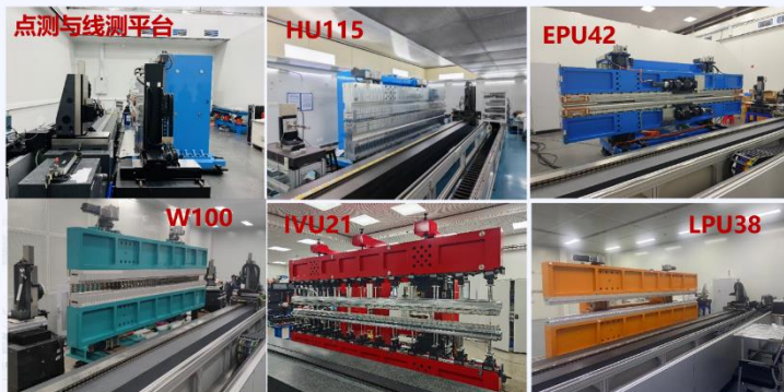
完成多台波荡器研制，正在陆续进行出厂与现场测试
