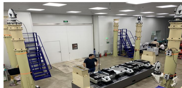
图 2-1 四路激光跟踪干涉三维坐标测量系统
