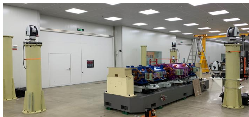
图 2-1 四路激光跟踪干涉三维坐标测量系统
