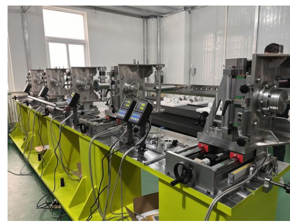
超长高精度真空内磁测系统
