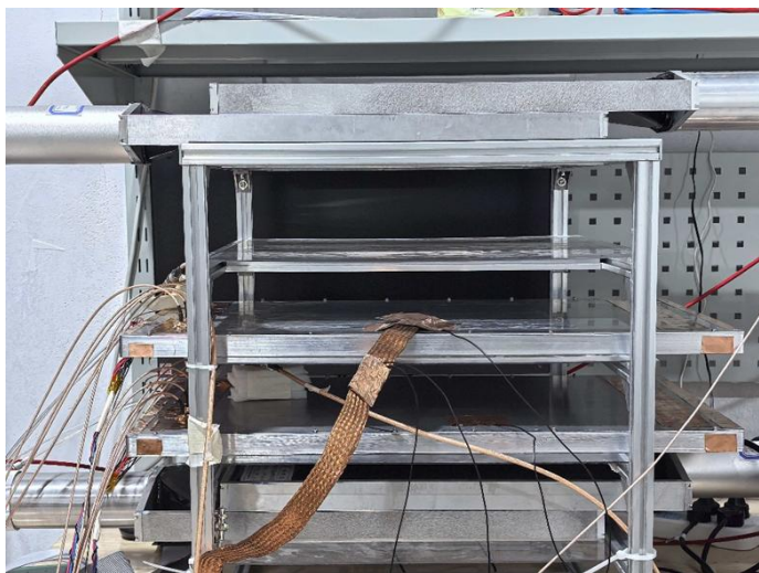
低阻玻璃RPC原型模块在进行宇宙线测试
