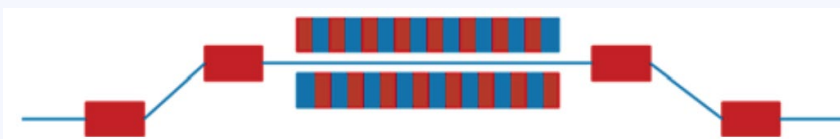
ALS-U利用Chicane在wiggler处产生局部色散
