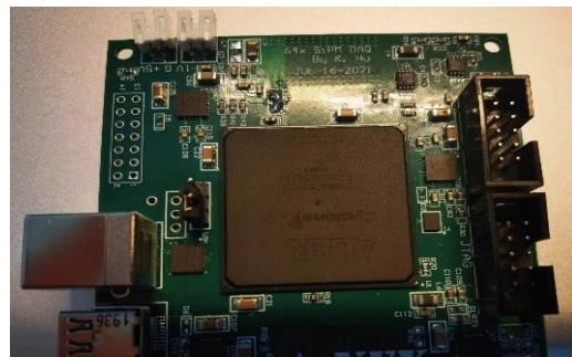
SiPM电子学系统研发 (适用于闪烁体探测器)
