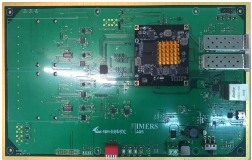
高集成数字化电子学系统研发 (适用于气体探测器和硅探测器)
