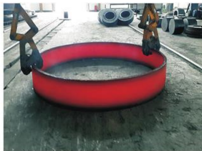
堆主容器用GH3535合金3米直径 大型环轧件
