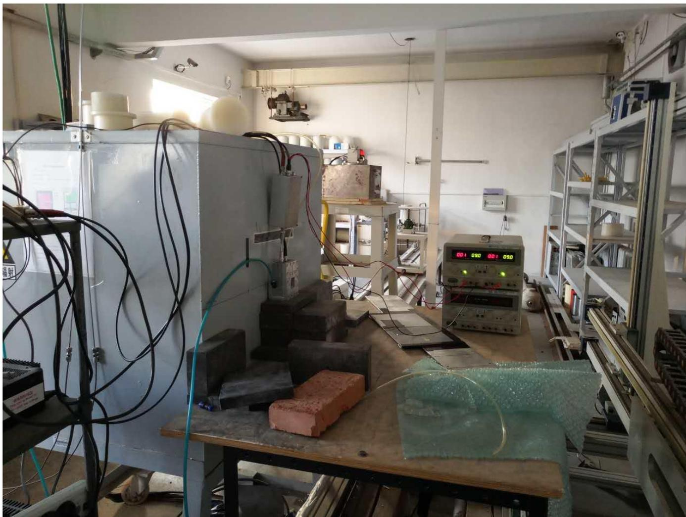
使用 $^{252}\text{Cf}$ 裂变中子源（未经慢化）， $^6\text{LiF}$ 作为转化层。
