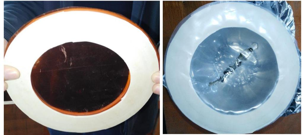
中子束窗测试：120微米Kapton（左）和Mylar膜（右）
