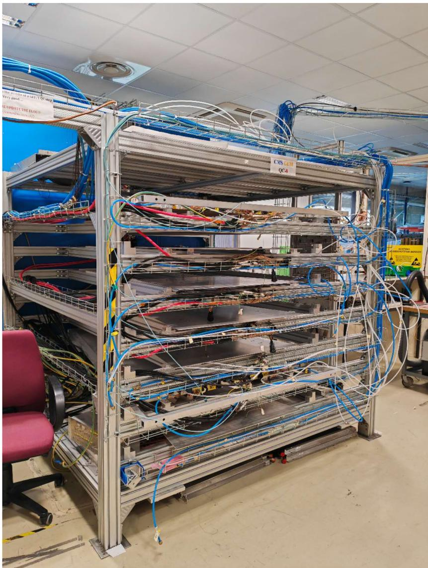
通过宇宙线平台，测试stack的时间分辨率及信号探测效率
