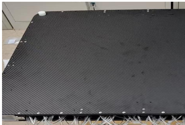
使用碳纤维板作为主要结构件，外覆盖电磁保护层
