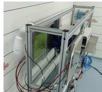
中国科技大学用于BNCT束流监测的基于Micromegas大面积高计数率中子探测器
