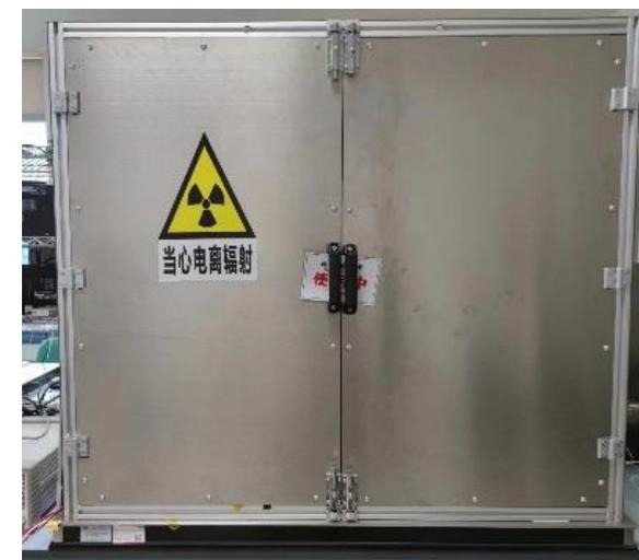
➤ 基于布拉格衍射原理，在实验室内构建了X射线偏振标定平台，产生单能偏振的X射线，用于对探测器进行标定。
