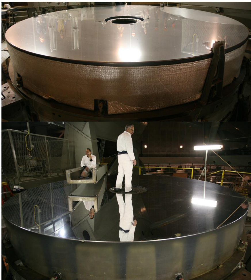
P200: 口径5.1m, 1949- 1992世界最大口径望远镜。主镜重量14.5吨, 厚度49.8厘米
