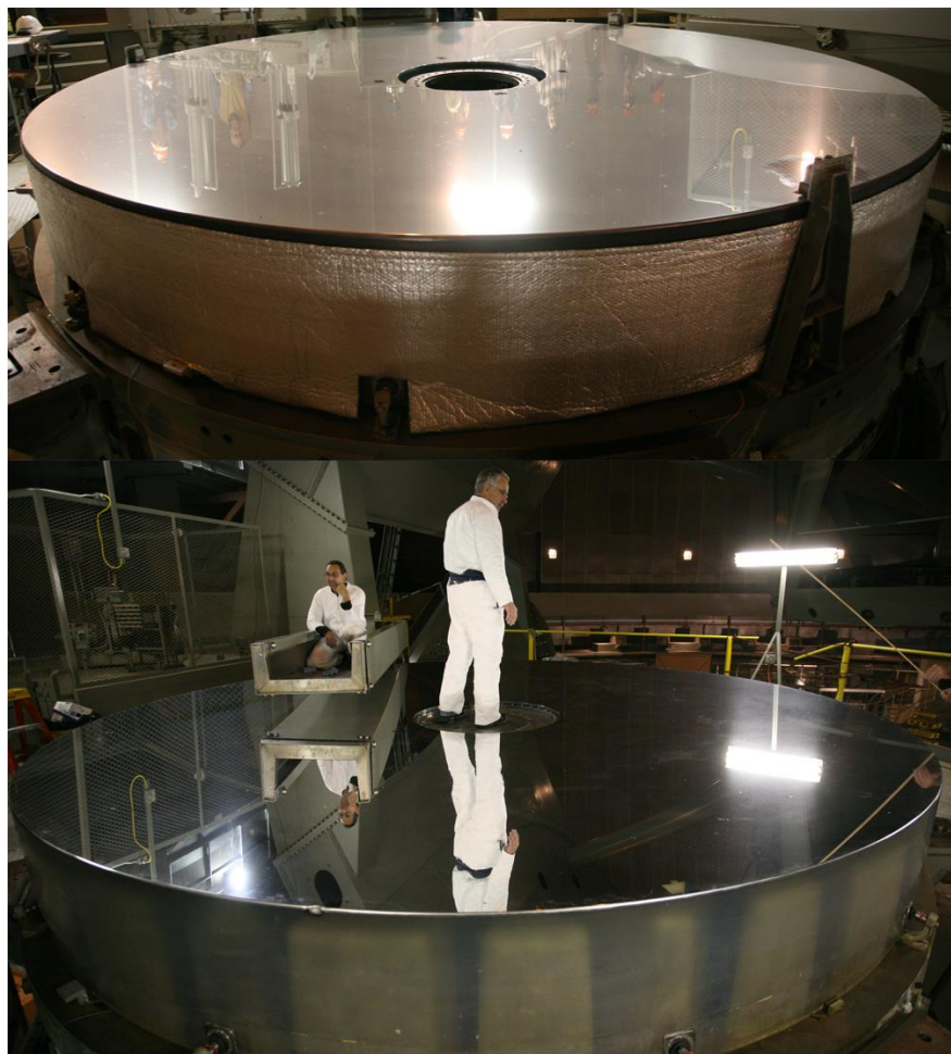
P200: 口径5.1m, 1949- 1992世界最大口径望远镜。主镜重量14.5吨, 厚度49.8厘米 (刚性厚反射镜)
