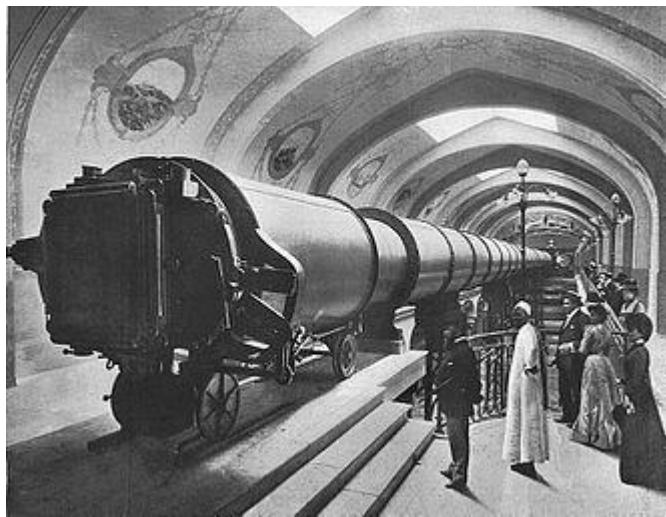
1900大巴黎展览望远镜：最大口径折射望远镜 1.25米 ，57米长，不适合天文观测，展览完即撤除
