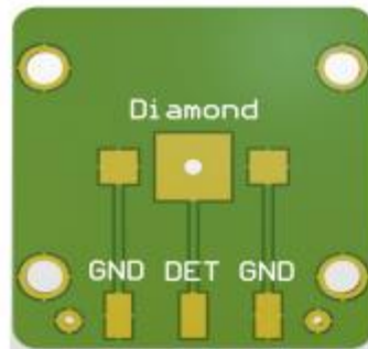
(a) 金刚石探测器的PCB板设计图
