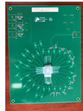
12通道接收芯片电测试板
