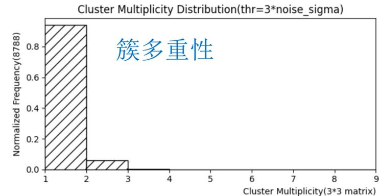
Fe源测试几乎只有单像素簇信号，似乎信号没有完全到达感应区。
