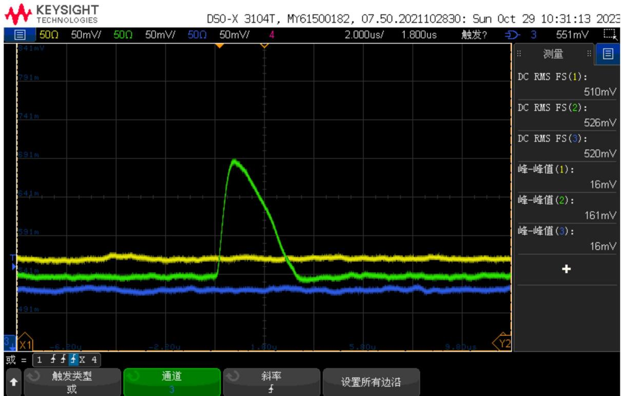
像素阵列芯片观测到的 $^{55}\text{Fe}$ 信号，160mV
