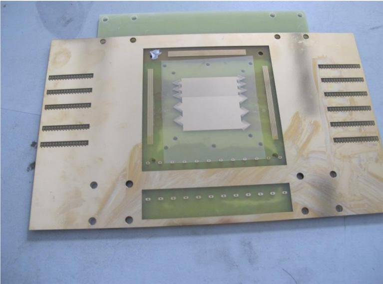
Readout of 1D GEM(200µm)
