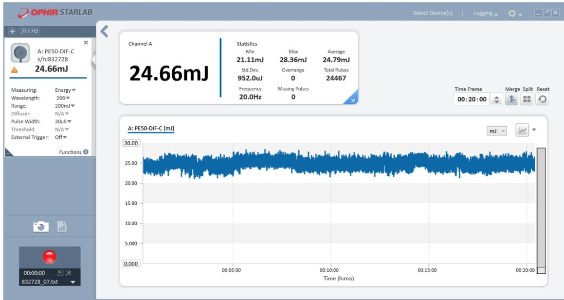
激光器高功率状态下能量稳定性测量
