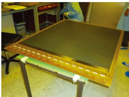
为ATLAS升级研制的1mx1m MM探测器
