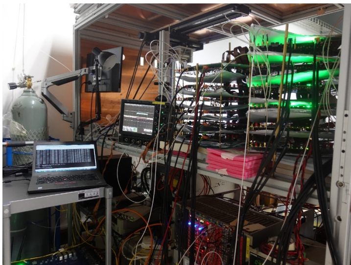
6层MM探测器联调, 中科大张志永老师提供
