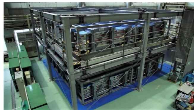
福岛第一核电站的缪子 成像检测装置
