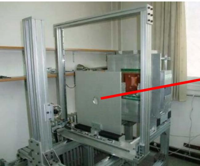
GEM探测器X光机测量平台
