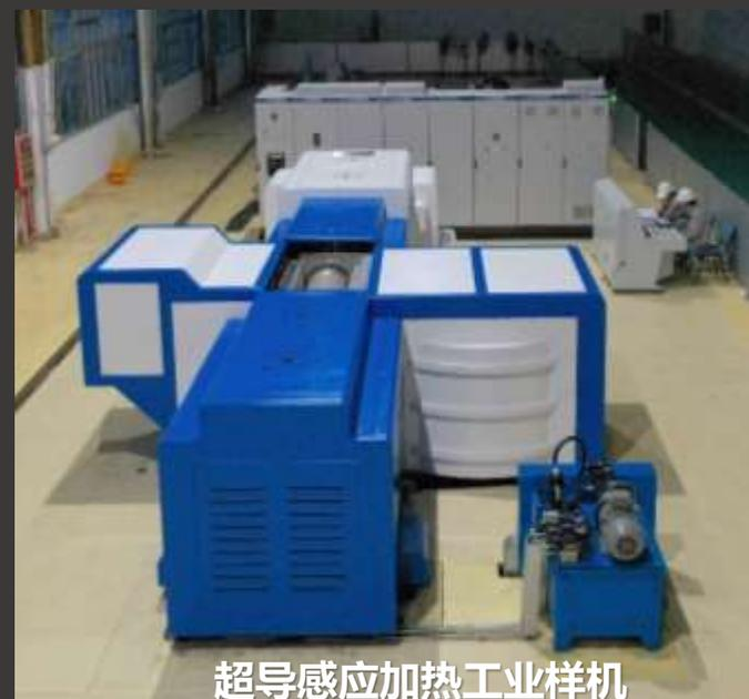
超导感应加热工业样机
