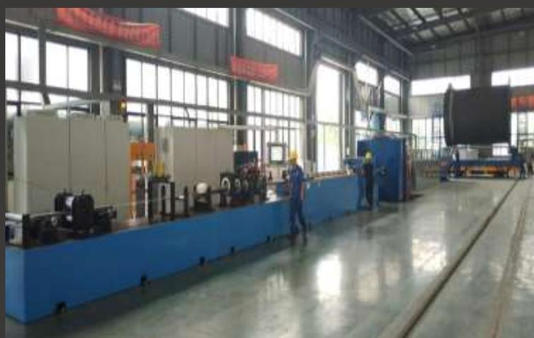
低温管道连续成型生产线
