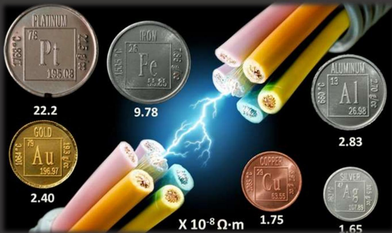
常规金属导体：有电阻  $\sim 10^{-8} \Omega \cdot m$
