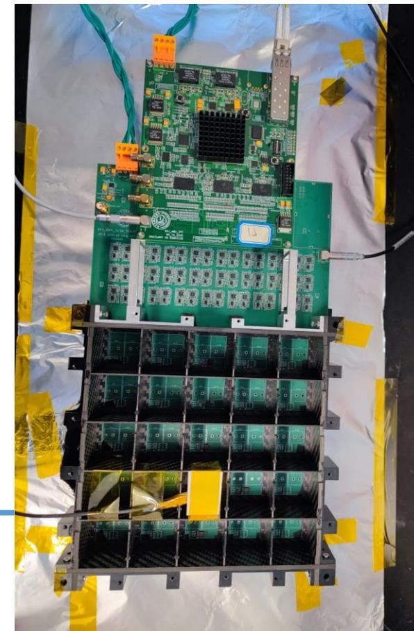
借助遮光片和电子学增益, 可以实现的动态范围:  $\frac{4096 - 890}{5 \times 4.813} \times 36.46 \times 31.09 \times 36.76 = 5.551 \times 10^6$
